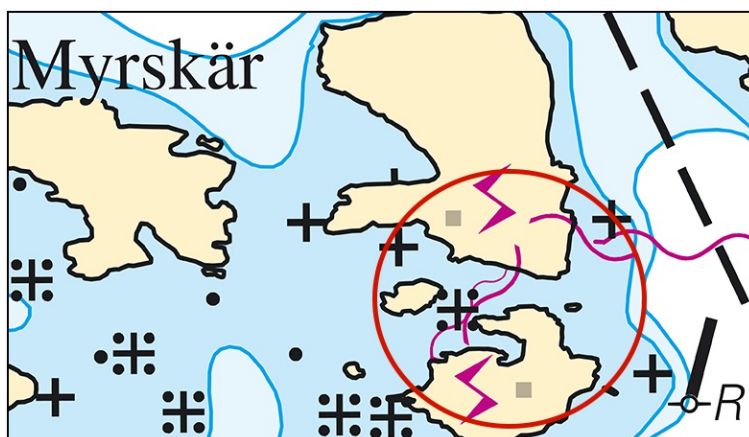
Myrskär. Submarine power cables
